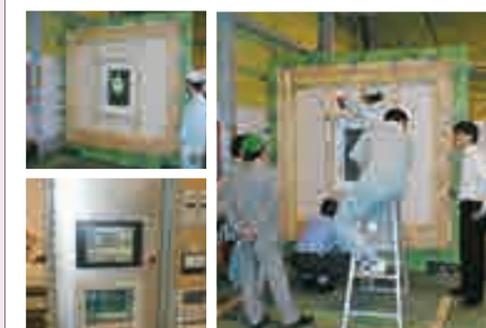
※外断熱工法による雨水浸入防止の証明試験 ※外断熱「止水ライン」風洞実験
